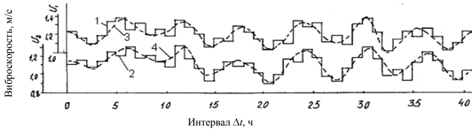
Рис. 2. Фрагменты изменения виброскорости (1, 2) и аппроксимированный график виброскорости насоса (3, 4): 1, 3 – насос высокого давления; 2, 4 – загрузочное устройство
