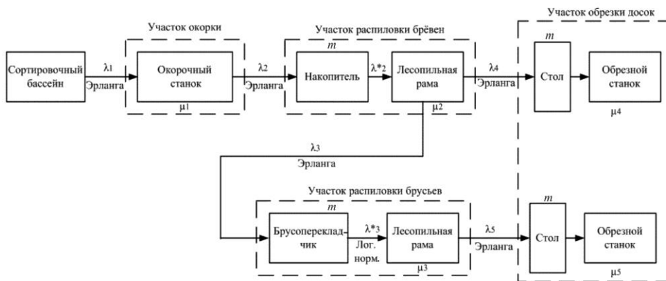
Рис. 1. Сетевая модель поточной линии производства пиломатериалов ( \lambda_{1-5} – интенсивность входящего потока требований на соответствующих участках; m – допустимое количество требований, находящихся в очереди на обслуживании (обработке); \mu_{1-5} – интенсивность обработки требований)
