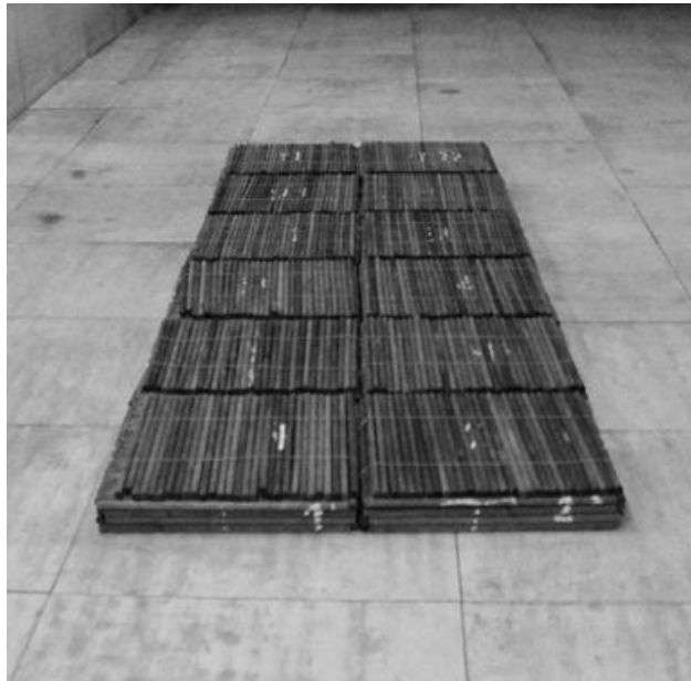
Рис. 1. Модель плота из двенадцати пятирядных ПСЕ
