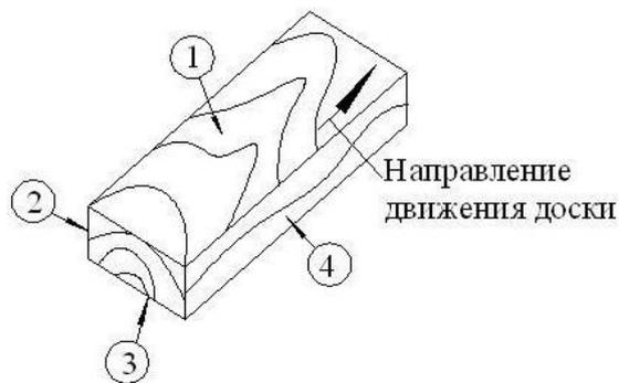
Рис. 1. Расположение обрабатываемых плоскостей (1 – 4) пиломатериала: 1 – верхняя, 2 – левая, 3 – нижняя, 4 – правая
