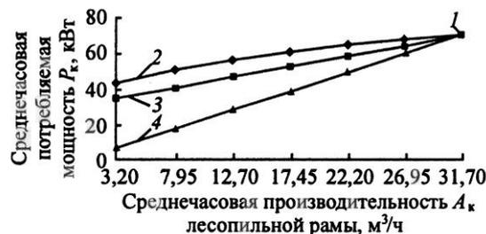
Рис. 4. Энергетические диаграммы средней потребляемой мощности ЛР за время  $T_k$ : 1 – режим 1; 2 – 2; 3 – 3; 4 – 4
