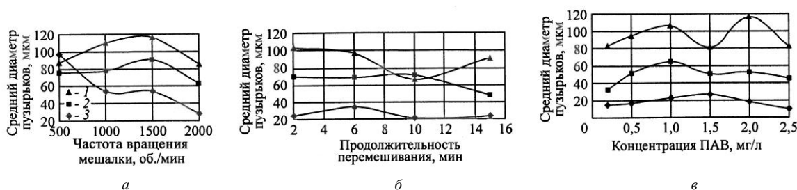
Рис. 3. Влияние числа оборотов мешалки (а), продолжительности перемешивания (б) и концентрации ПАВ (в) на средний диаметр пузырьков пены: 1 – спустя 10 мин после отключения мешалки; 2 – 5 мин; 3 – сразу после отключения
