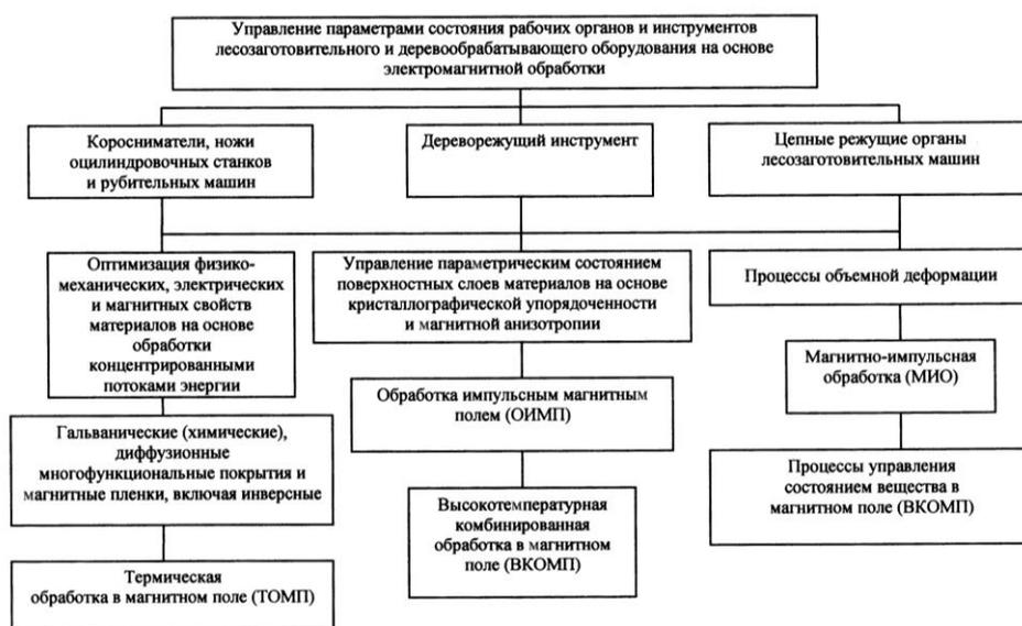
Рис. 2. Схема управления параметрами, определяющими работоспособность дереворежущих устройств
