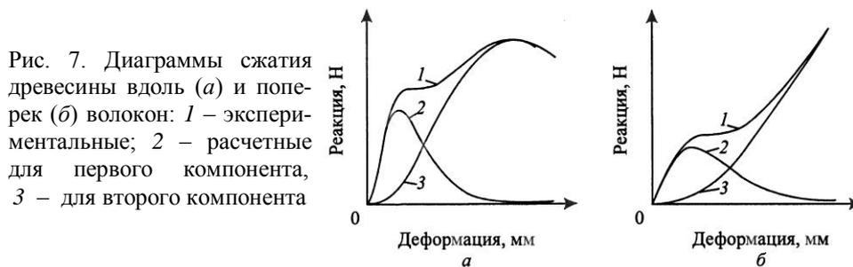
Рис. 7. Диаграммы сжатия древесины вдоль (а) и поперек (б) волокон: 1 – экспериментальные; 2 – расчетные для первого компонента, 3 – для второго компонента
