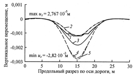
Рис. 3. Вертикальные перемещения u_z в плоскости симметрии x = 0 : 1 – на поверхности покрытия ( z = 0,5 м); 2 – на кровле эквивалентного слоя ( z = -3,5 м); 3 – на кровле 3-го слоя ( z = -2,1 м); 4 – на кровле 1-го слоя ( z = 0 м); 5 – на кровле 2-го слоя ( z = -0,9 м). Вдоль оси абсцисс отложены расстояния по оси дороги
