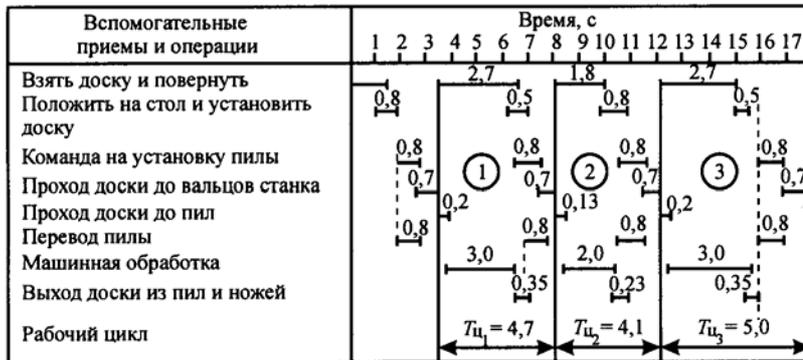
Рис. 2. Циклограмма работы обрезного станка при разной продолжительности рабочего цикла
