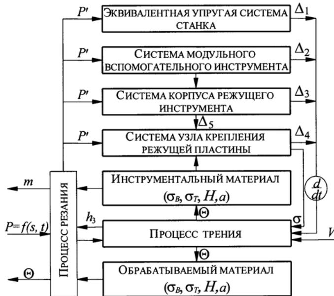
Рис. 2. Динамическая модель технологической системы (ТС):  $V, S, t$  – режимы резания;  $\sigma_v, \sigma_t, H, a$  – механические характеристики инструментального и обрабатываемого материалов;  $\Delta_i$  – упругие деформации ТС;  $m, \Theta$  – масса и теплота стружки;  $P$  и  $P'$  – расчетная и действительная силы резания;  $\sigma$  – напряжение
