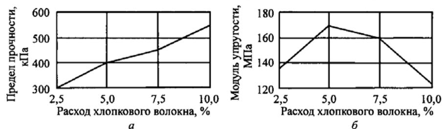
Рис. 2. Влияние расхода волокон хлопковой целлюлозы на предел прочности (а) и модуль упругости (б) стекловолоконного материала (масса  $1 \text{ м}^2$  – 7,3 г)
