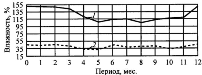
Рис. 4. Изменение влажности заболонной (1) и ядровой (2) древесины ели в течение года [9]
