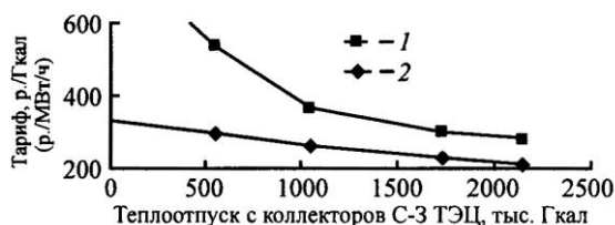
Рис. 6. Тарифы на тепло- и электроэнергию при работе одного блока: 1 – электроэнергия, 2 – тепловая энергия
