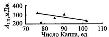
Рис. 7. Влияние степени делигнификации сульфатной хвойной ЦВВ на работу, затрачиваемую на рост трещины в стадии разрушения образца (• – производственный образец)
