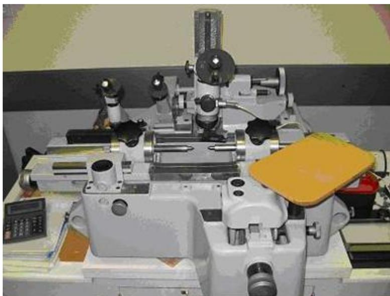
Рис. 4. Универсальный измерительный микроскоп УИМ-21
