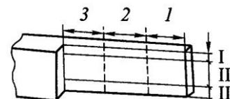
Рис. 1. Схема расположения областей (1 – 3) и зон (I – III) пиления
