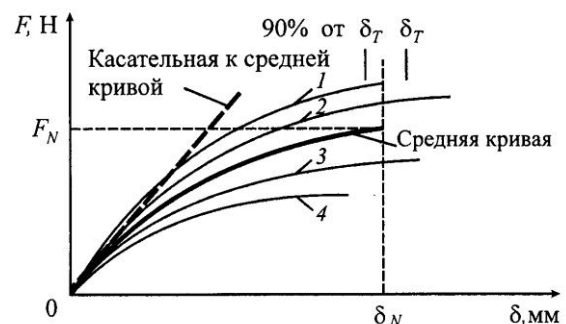
Рис. 6. Принцип вычисления величин характеристик при испытании на растяжение: \delta_N – номинальное удлинение; c – максимальный наклон касательной; \bar{\delta}_T – среднее удлинение при разрыве ( 4 – отброшенная кривая)
