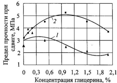
нах и выдерживали под давлением  $5 \text{ кг/см}^2$  в течение суток, затем их освобождали от зажимов и выдерживали при комнатной температуре еще трое суток. Горячее склеивание образцов проводили в прессе для пластических масс марки Д 2430Б с размерами плит  $350 \times 390 \text{ мм}$  ( $t = 130 \text{ }^\circ\text{C}$ ,  $P = 5 \text{ кг/см}^3$ ,  $\tau = 10 \text{ мин}$ ) После чего вырезали стандартные образцы для испытания предела прочности при сдвиге.
