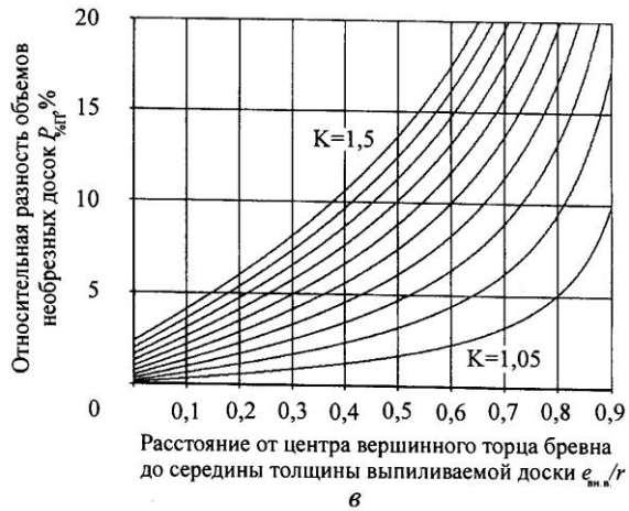
Рис. 2. Изменение относительной разности объемов необрезных досок P_{гр} толщиной 0,05d ( a ) и 0,35d ( б ) в зависимости от способа распиловки бревен: a , б – до внутренней пласти доски; в – до середины толщины доски
