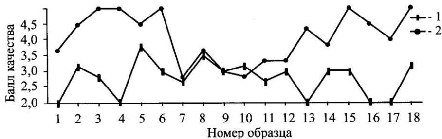
Рис. 3. Влияние изолирующего грунта на качество покрытия: на необессмоленной древесине с красителем (1) и изолирующем грунте (2)
