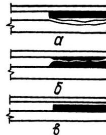
проникновения клея в структуру бумаги. При оценке качества склеивания следует принимать во внимание как адгезионную способность клея, так и когезионную способность целлюлозного материала. Таким образом, если сам материал не обладает достаточной прочностью в *z*-направлении и его когезионная способность лимитирует прочность клевого соединения, то не имеет смысла повышать адгезионную способность и расход клея.
