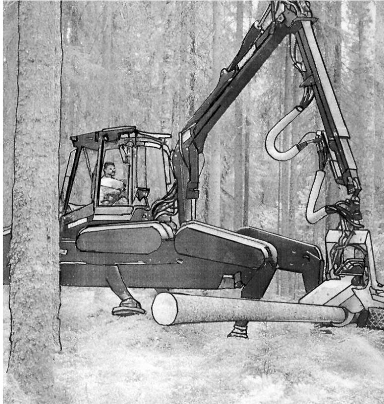
Рис. 1. Шагающий многооперационный аппарат фирмы TIMBERJACK (Канада)
