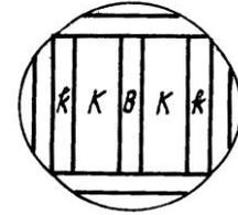
Рис. 3. Схема постова для получения пиломатериалов повышенной плотности
