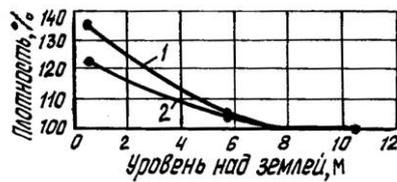
Рис. 2. Зависимость плотности древесины от уровня над землей: 1 – наиболее плотные слои; 2 – средняя плотность
