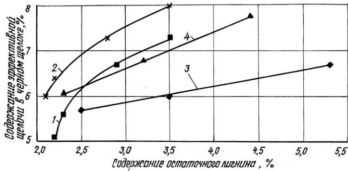
Рис. 3. Зависимость содержания эффективной щелочи в черном щелоке от содержания остаточного лигнина в древесном остатке (см. обозначения на рис. 1)
