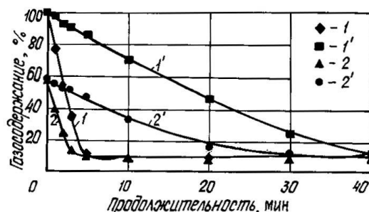
Рис. 2. Зависимость газосодержания реакционной смеси от продолжительности дегазации: 1, 2 — ультразвуковая дегазация; 1', 2' — контрольный опыт без ультразвука; 1, 1' — смесь из закрытого реактора; 2, 2' — смесь из открытой емкости
