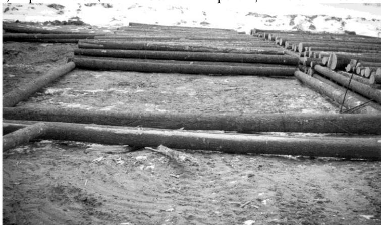
Рис. 2. Изготовление плота из плоских сплоточных единиц на плотбище
