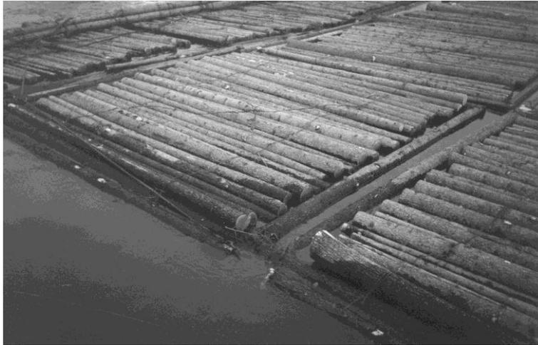
Рис. 1. Плот из плоских сплоточных единиц конструкции АГТУ
