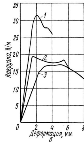
Диаграмма сжатия древесины хвойных пород поперек волокон в радиальном (а) и тангенциальном (б) направлениях при влажности 10 (1), 30 (2) и 80 % (3)
