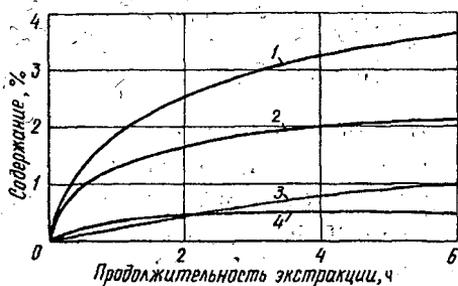
Рис. 3. Кинетика выхода экстрактивных веществ при углекислотной экстракции коры пихты: 1 - летучие компоненты; 2 - монотерпены; 3 - сесквитерпены; 4 - кислородсодержащие вещества
