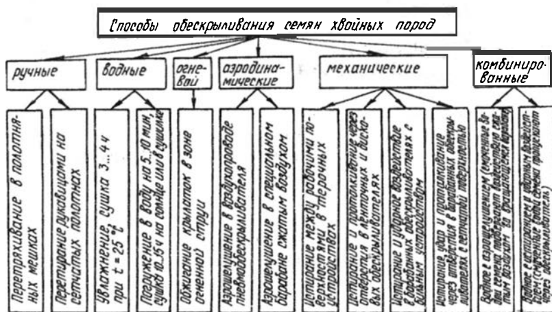
Рис. 1. Структурная схема существующих способов обескряливания семян и технических средств, осуществляющих их
