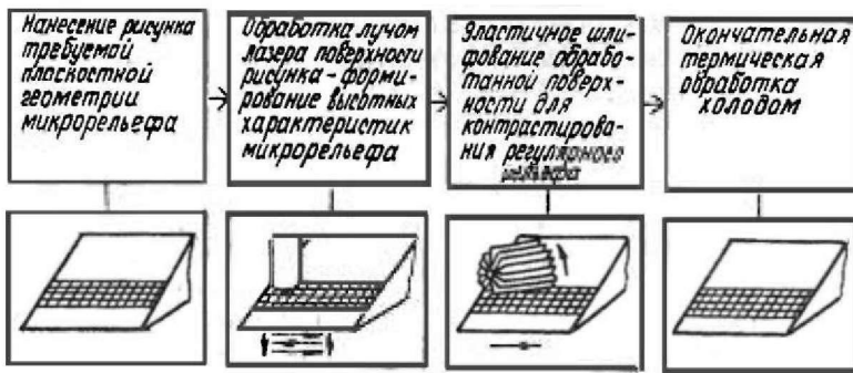
Рис. 2. Схема лазерного упрочнения инструмента с созданием регулярных микрорельефов
