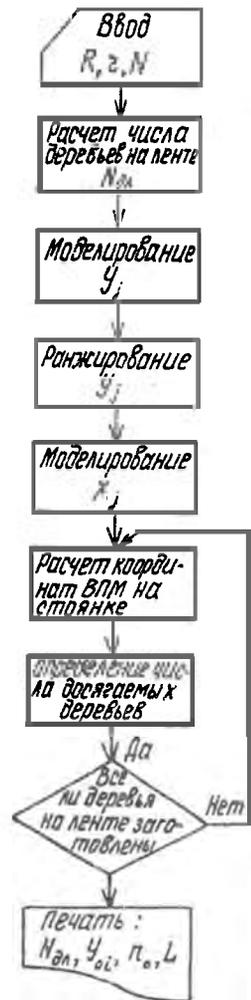
Рис.2. Принципиальная блок-схема работы полноповоротной ЛЗМ
