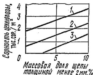
Рис. 4. Зависимость сорности целлюлозы из соснового сырья от массовой доли щепы толщиной менее 2 мм при массовой доле стружки 0 (1), 5 (2), 10 % (3) (щепы толщиной более 7 мм отсутствует)
