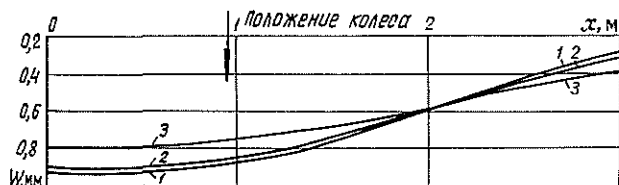
Рис. 2. Осадка конструкции в поперечном направлении.
