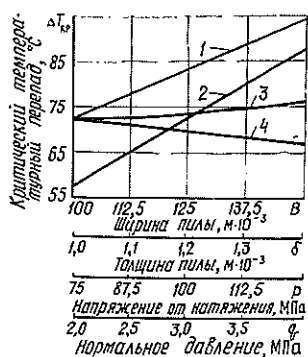
Рис. 2. Зависимость критического температурного перепада по ширине ленточной пилы от различных факторов (свободная длина рабочего участка 0,450 м).
