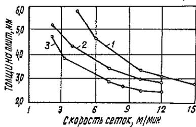
Рис. 2. Зависимость толщины плит от скорости сеток при угле их схождения в зоне формирования  $7^\circ$  и концентрации древесноволокнистой массы 1,6 % (1), 1,2 % (2) и 1,0 % (3).
