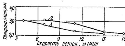
Рис. 3. Зависимость толщины плит от скорости сеток при угле их схождения в зоне формирования  $12^\circ$  и концентрации древесноволокнистой массы 1,6 % (1) и 1,9 % (2).
