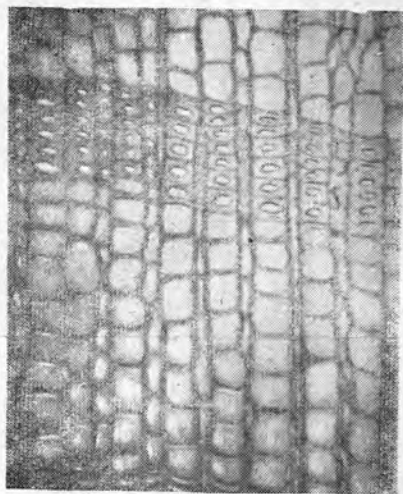
Рис. 9. Торцовый срез древесины сосны 1-й степени деградации, увелич. в 80 раз.
