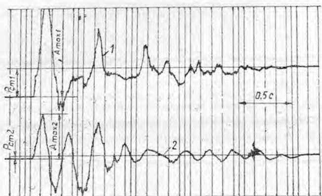
Рис. 2. Осциллограмма перемещений подпружиненной балки при ударе дерева.
