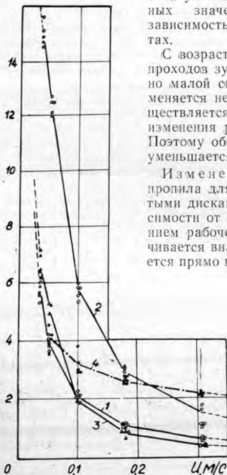
Рис. 2. Графики зависимости удельной работы резания K круглой пилой от скорости подачи U .
