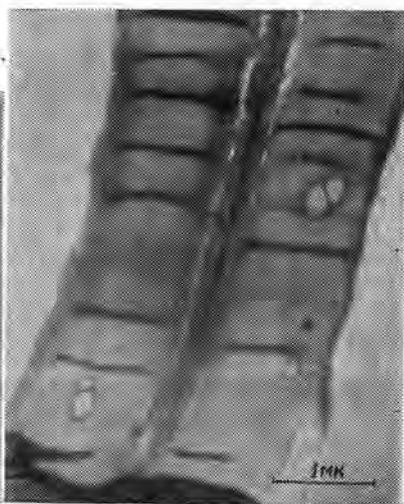
Рис. 4. Поперечный срез частично делигнифицированной древесины.
