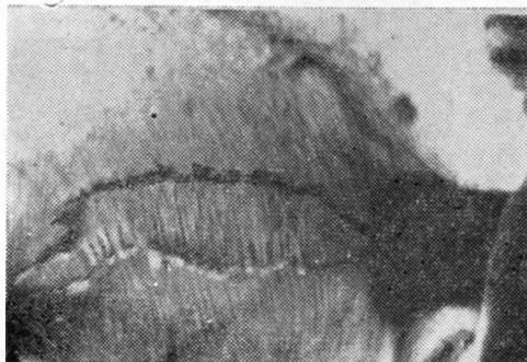
Рис. 4. Микрофотография мацерированного волокна ели, окрашенного «викторией голубой В». Бусообразование под действием раствора куприэтилендиамина. В бусине видна третичная стенка (увелич. в 169 раз).
