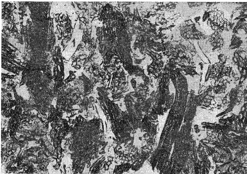
Рис. 1. Микрофотография целлюлознопрессованного древесного пластика с добавкой графита (увеличение в 100 раз).
