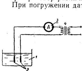
Рис. 2. Электрическая схема прибора для контроля концентрации раствора.
