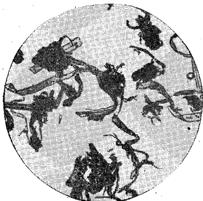
Рис. 3. Сульфитная небеленая целлюлоза, размолотая в бензине на мельнице Лампена.
