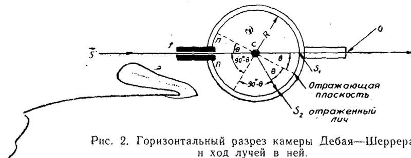
Рис. 2. Горизонтальный разрез камеры Дебая—Шеррера и ход лучей в ней.
